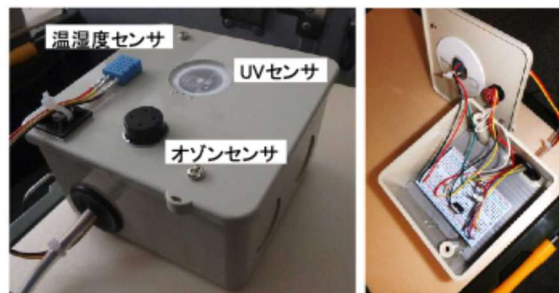
図-5 センサボックス（左：外観、右：内部）
