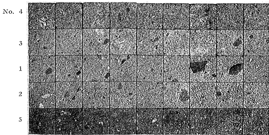
写真第一 角礫凝灰岩の供試體
