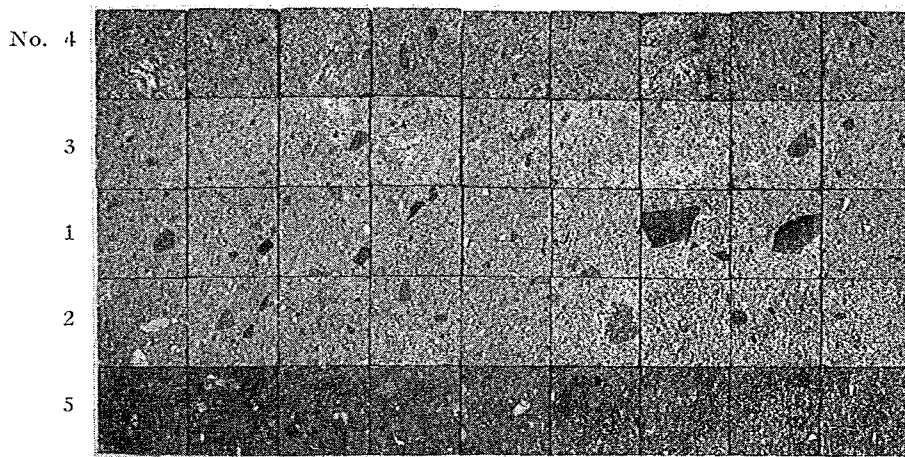
写真第一 角礫凝灰岩の供試體
