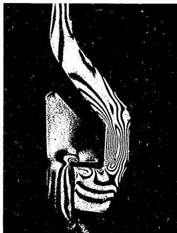
寫真第十五 Hoesch 型繼手等明曲線
