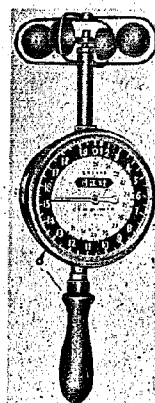
写真—6 大田式ハ ンド風速計の外観
