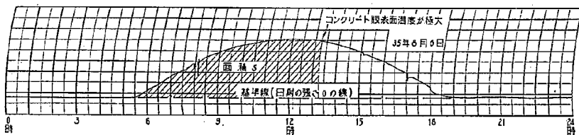
図-91 ロビッチ日射計による日射の強さの1日間の変化の1例(快晴の場合)
