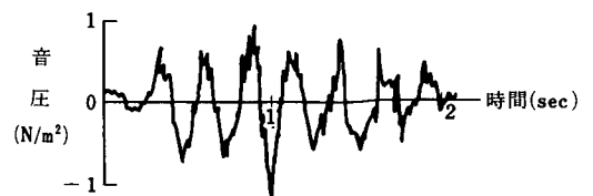
図-7-25 空気振動の応答(PC・T桁橋C)
