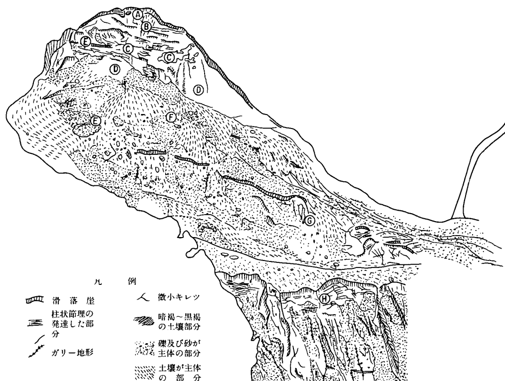
図-4.33 滝越地区崩壊源頭部斜め写真判読図
