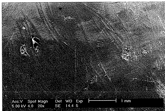
図-3.6 高湿度劣化試験後の外観(SEM) (Type2, 60°C 85% 210 日間)
