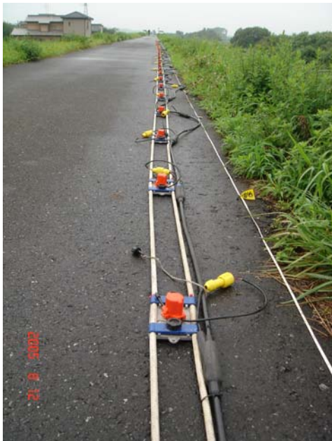
(c) A photo of the surface wave type Land Streamer (c) 表面波ランドストリーマーの外観
