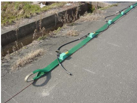
(b) A photo showing P-wave type Land Streamer (b) P波タイプランドストリーマーの外観
