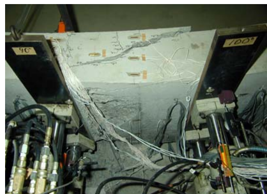
写真-2.4 実験の最終状態 (ケース A-5d, 90 度外面)
