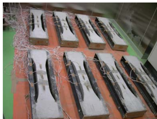
写真-3.1 拘束供試体の設置状況
