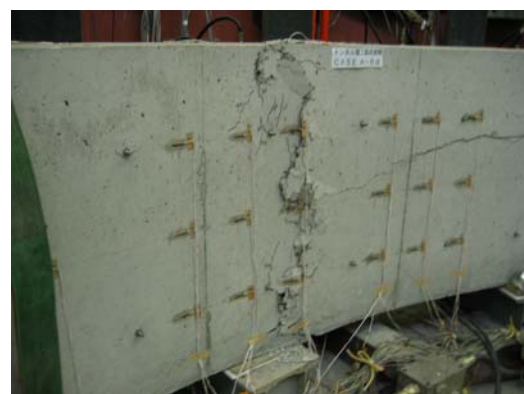
写真-2.6 実験の最終状態 (ケース A-6d, 115 度内面)
