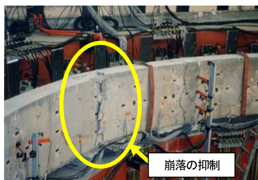
写真-2.3 実験の最終状態(ケース A-2)
