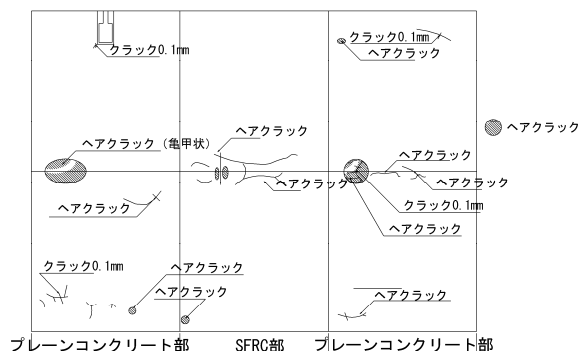
図-3.25 B トンネルの覆工コンクリート内面観察結果(試験施工区間②)
