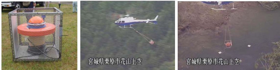
図-4.25 投下型水位観測ブイの外観と設置状況 (左：ブイ外観、中：ヘリコプターで輸送中の様子、右：設置中)
