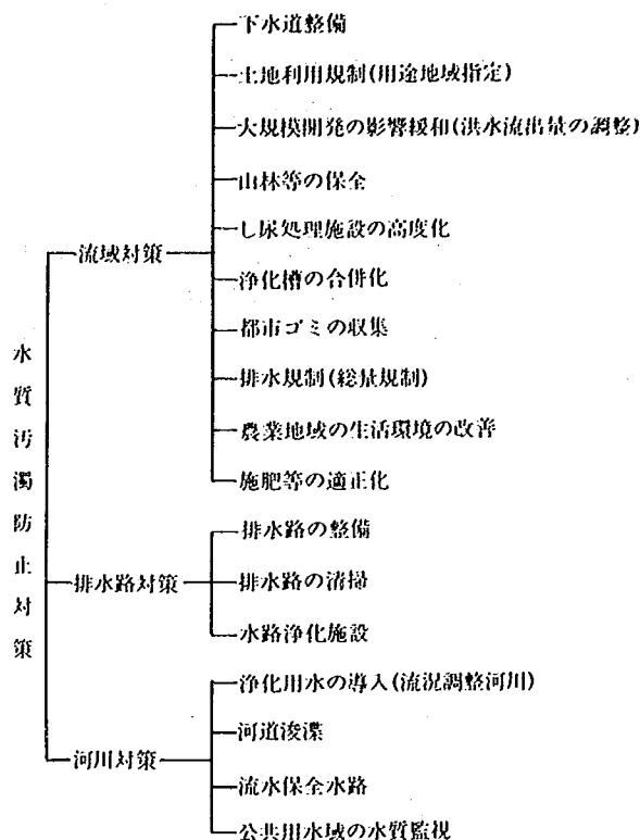
図-1・1 水質汚濁防止対策
