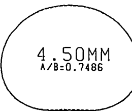
図-3.3.2 高度差による変形雨滴形状の違い
