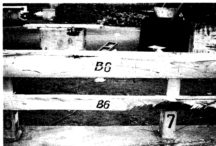
〔写真2-10〕 前輪衝突による圧痕状況
