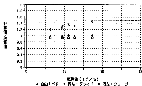
図-6.7 雪崩予防柵に作用する雪圧
