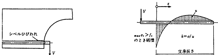
図-1 鉄筋のジベル効果の機構
