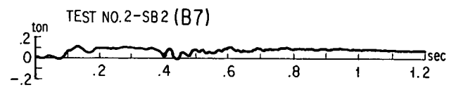
図一付 1. 5.20 下段横梁に作用した曲げモーメント (実験 2)
