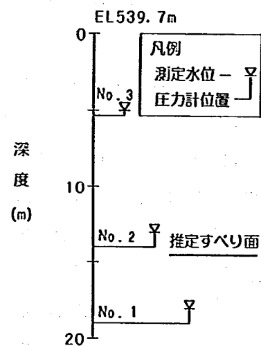
図-6.3.8 初期水圧測定結果
