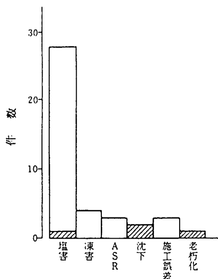
図-1.1 構造物の劣化要因別件数
