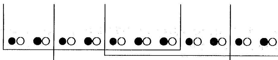
図解-4 横補強筋の例
