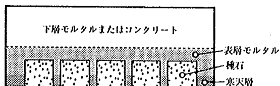
図 4.5.2 種石だけを研ぎ出した擬石ブロックの製造方法
