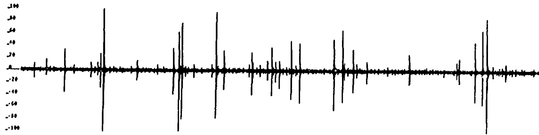
砂の三軸せん断試験時のA E（荷重80%前後）
