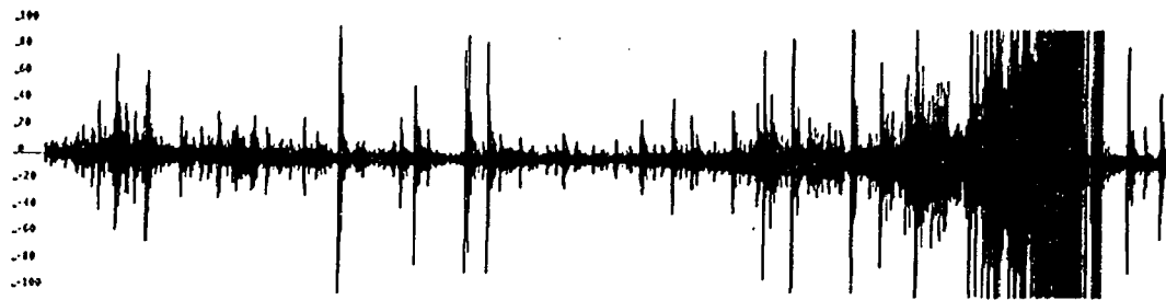
砂岩の静的破碎実験における破壊時のA E
