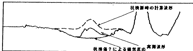
図-4.5.17 No. 1 杭付近の磁気状況
