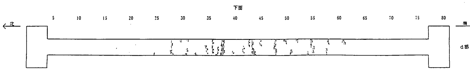
ひび割れ状態スケッチ図 (供試体番号 NQ. GS-2)
