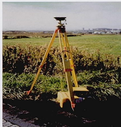
図 3.2-1 地上 GPS 基準点の設置例
