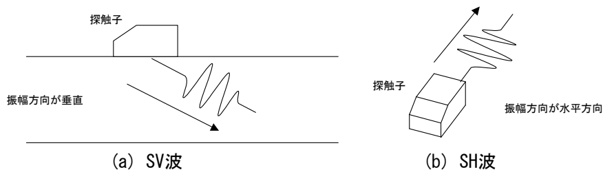
図-4.3 斜角探傷に用いられる横波イメージ
