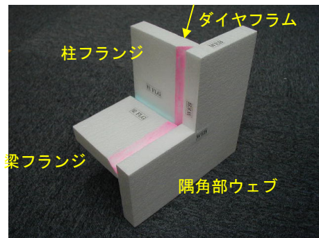
(a) 角柱断面（角柱WWタイプ）
