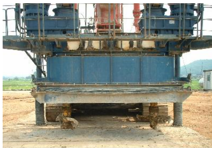
写真4.2.2 攪拌翼部分(軸間距離 2500mm)
