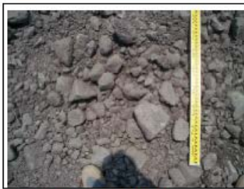
転圧前の盛土材（最大粒径15～20cm）
