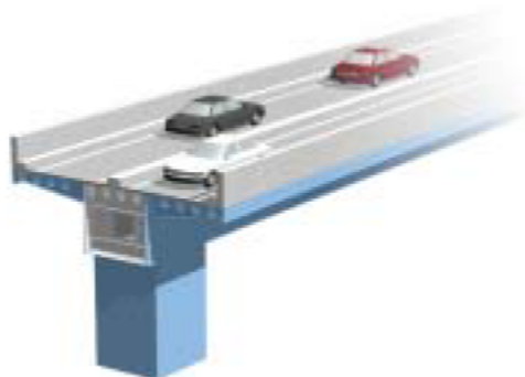
図-2.3 上下部一体構造（一箱桁）
