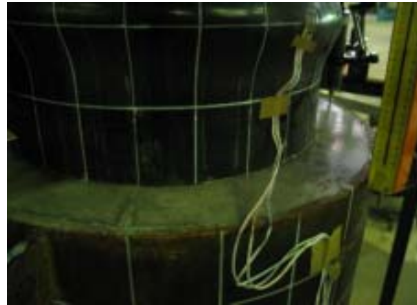
(b) コンクリート面（ひび割れ発生なし）
