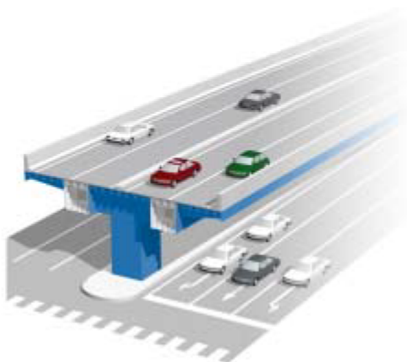
図-2.4 上下部一体構造（二箱桁）
