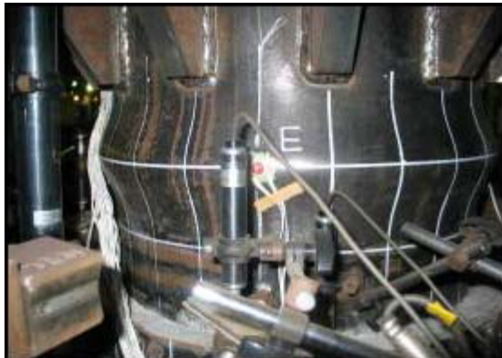
写真-4.2.6 座屈発生状況 (A-3)
