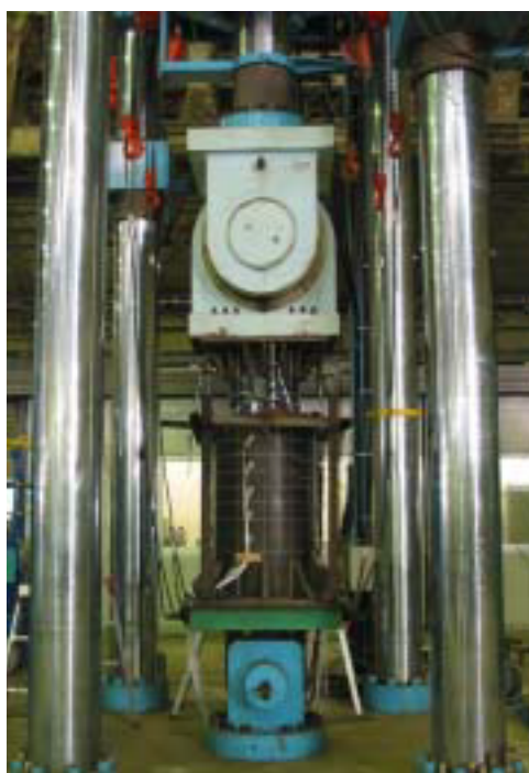
写真-4.2.2 引抜き実験状況
