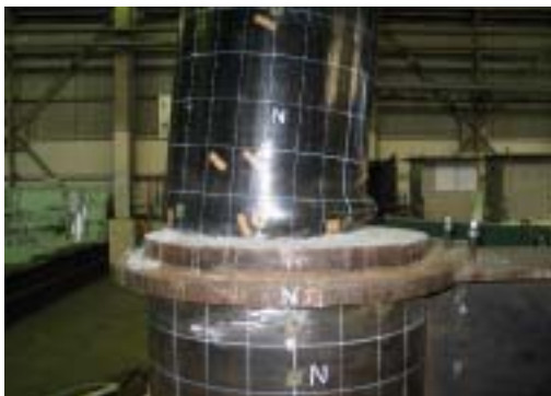
(a) 載荷直交方向の終局状態（B-3）
