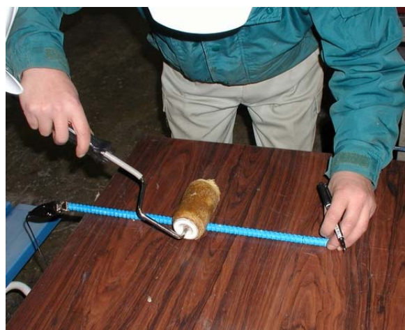
写真－Ⅱ－3 ひび割れ有無の確認状況
