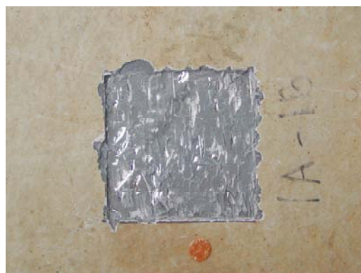
図－Ⅲ－９ 塗膜下鋼素地観察 No.2 : 有機ジンクリッチ／ ガラスフレーク入りポリエステル 塗装系
