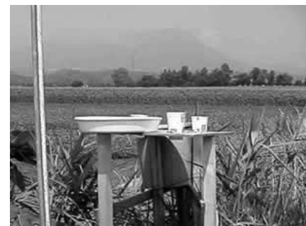
図 2. 2. 1. 5 火山灰トラップ設置状況 1) (紙コップと洗面器が設置してある)
