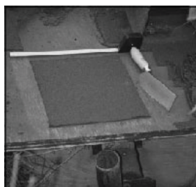
図 2.2.1.14 固い台の上で火山灰の定面積採取の状況(左)と回収の様子(右)
