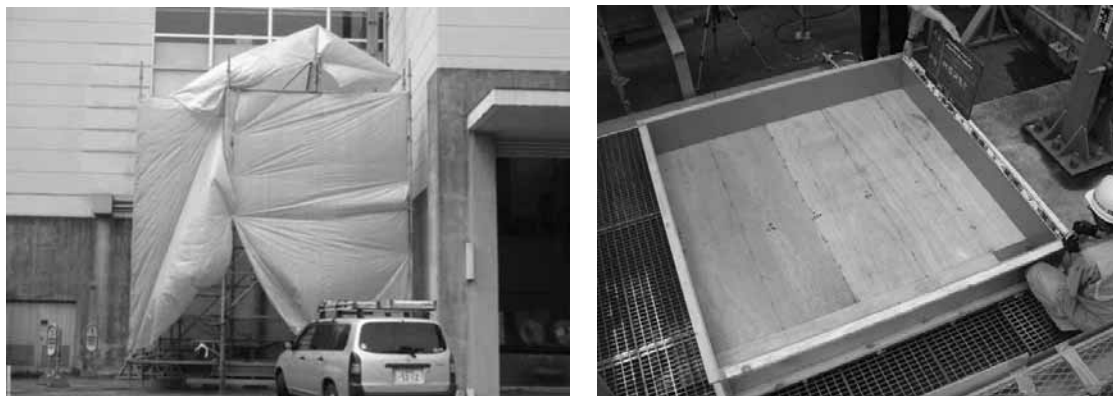
図 2.2.2.8 実験装置の外観 (左：やぐら全景、右：下部の受容器)
