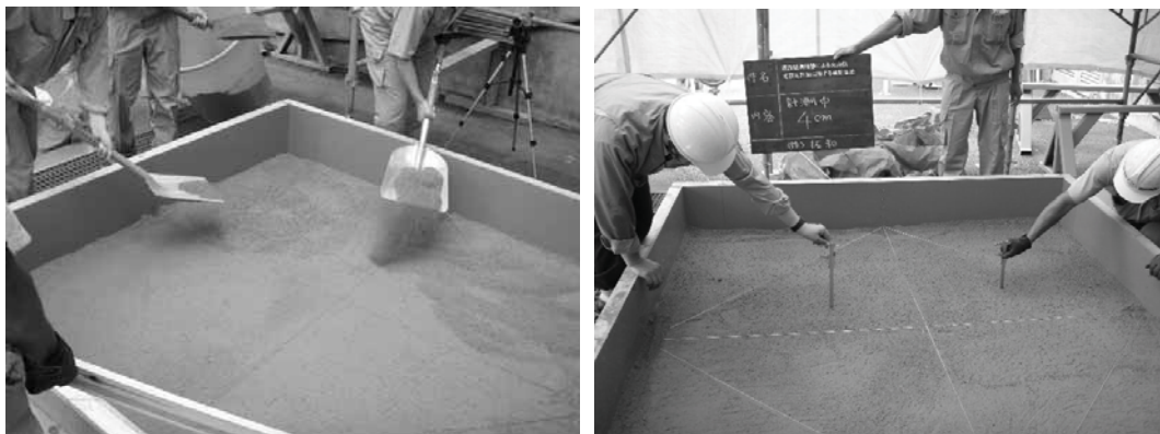
図 2.2.2.12 実験状況 (左：火山灰敷き詰め状況、右：堆積厚 4cm の状況)
