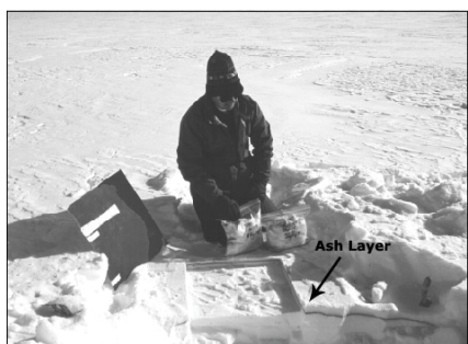
図 2.2.1.15 雪にパッキングされた火山灰を雪ごと採取している
