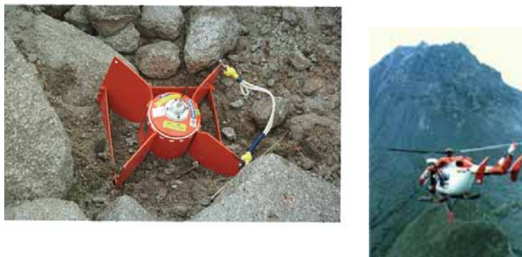
図 2.3.3 九州大学などが雲仙普賢岳へ投下したペネトレータ
