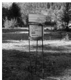
図 2.2.1.11 三脚と二重に重ねたバケツの設置および回収状況 9)
