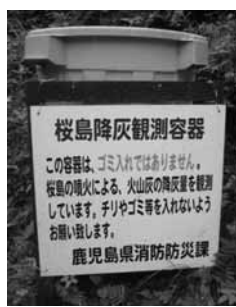
図 2.2.1.1 降灰観測容器写真 (左：中身、右：正面)
