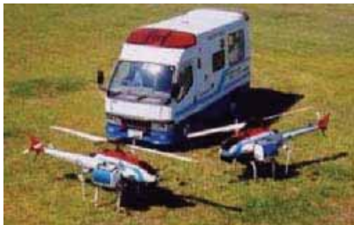
図 2.3.1 北海道開発局が既に多くの運用実績を持つ自律航行可能なヘリコプター調査システム 『岸寛人・中野智史・中島知幸（2007）小形無人ヘリコプターによる調査と今後の活用について、 第 50 回（平成 18 年度）北海道開発局技術研究発表会。』
