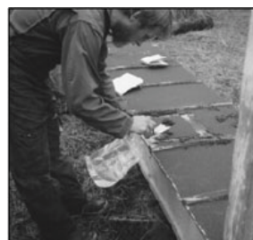
図 2.2.1.14 固い台の上で火山灰の定面積採取の状況(左)と回収の様子(右)
