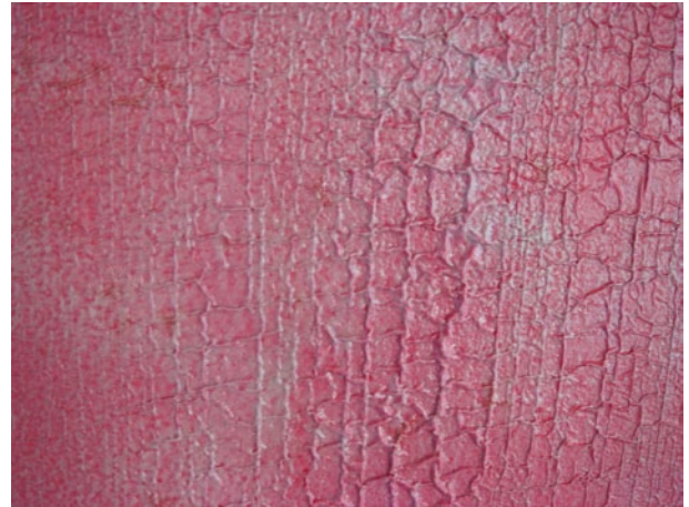
写真解－34 上層塗膜が大きく縮んだ例
