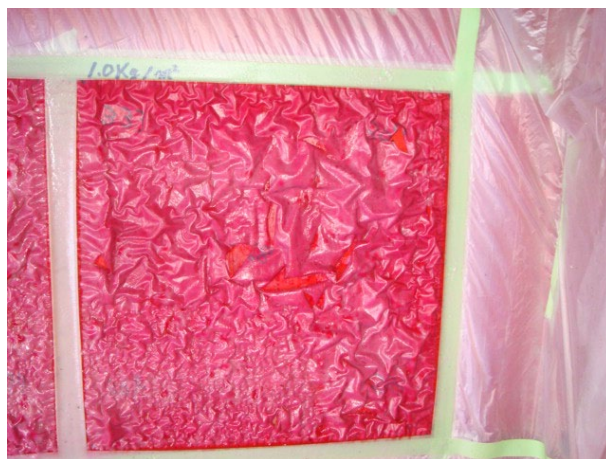
写真解-10 軟化反応(24時間後)
