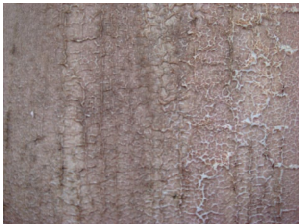
写真解-41 最上層塗膜が乾燥した状態
