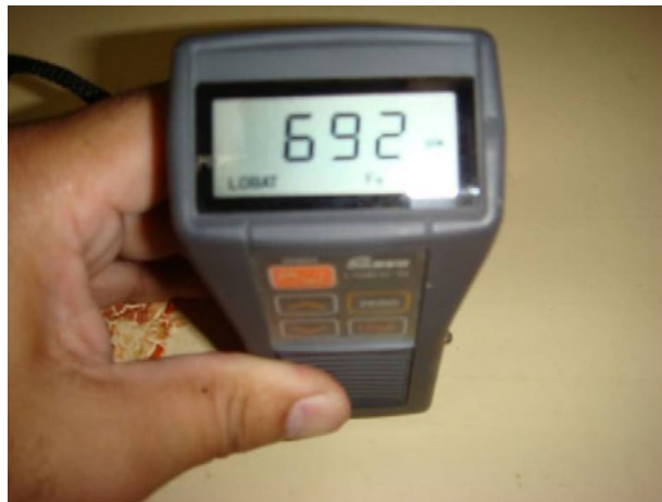
写真解－2 塗膜厚測定のを例
