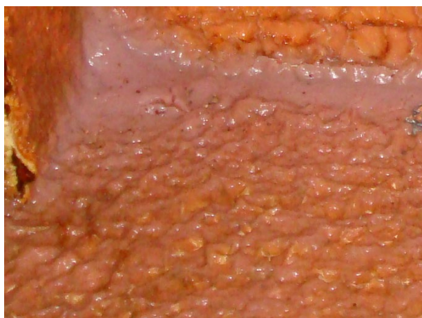
写真解－39 適切な塗付量より多い場合
