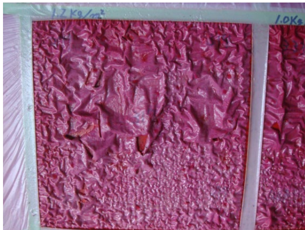
写真解-17 ポリウレタン樹脂塗料の軟化
