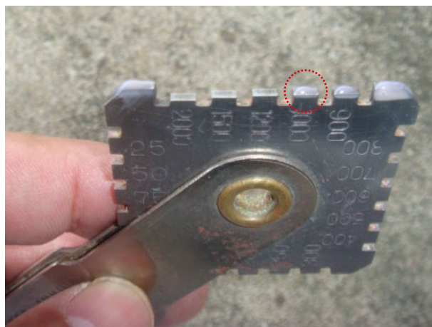
写真解－32 ウェットフィルムゲージによる塗付量確認
