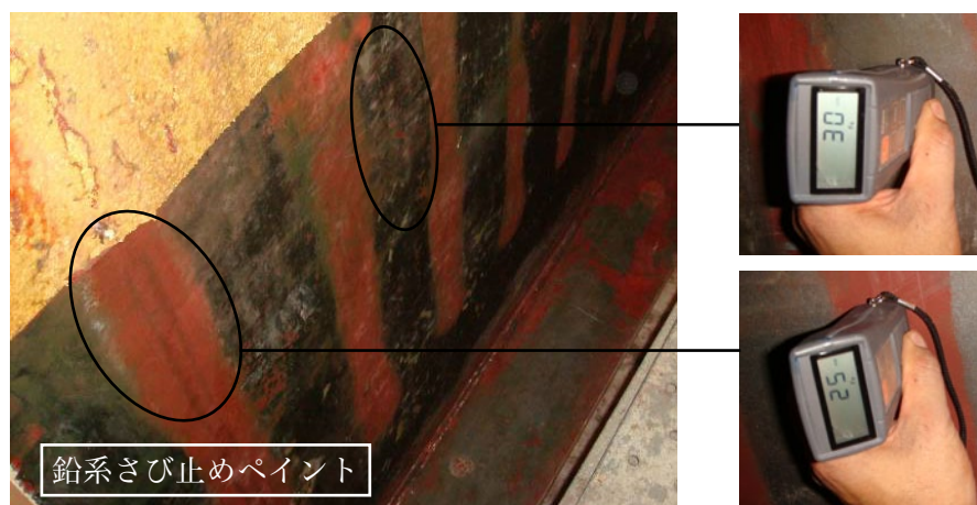
写真解-48 塗膜除去後の色合いに差異が生じた例
