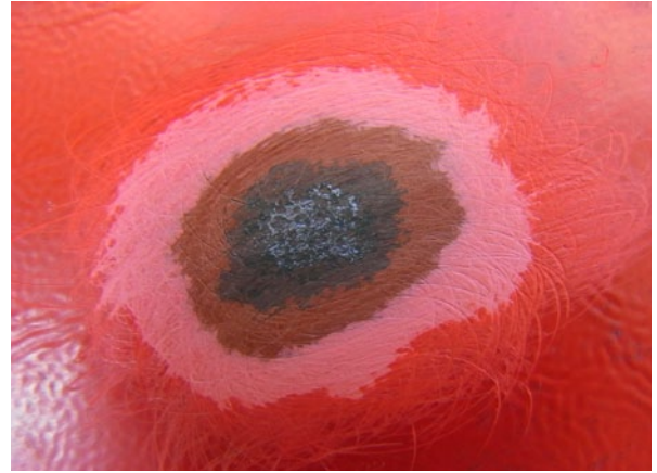
b) サンドペーパー研磨による塗膜構成の確認
