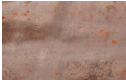
c) 軽微な電動工具処理(ディスクサンダー)
