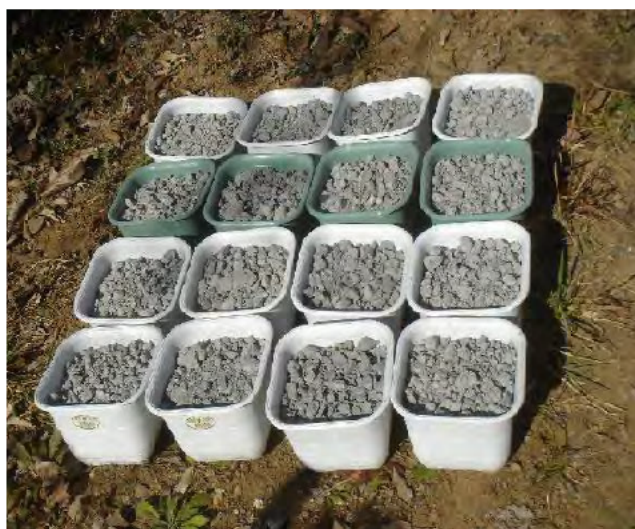
写真 2.3-1 屋外における暴露状況
