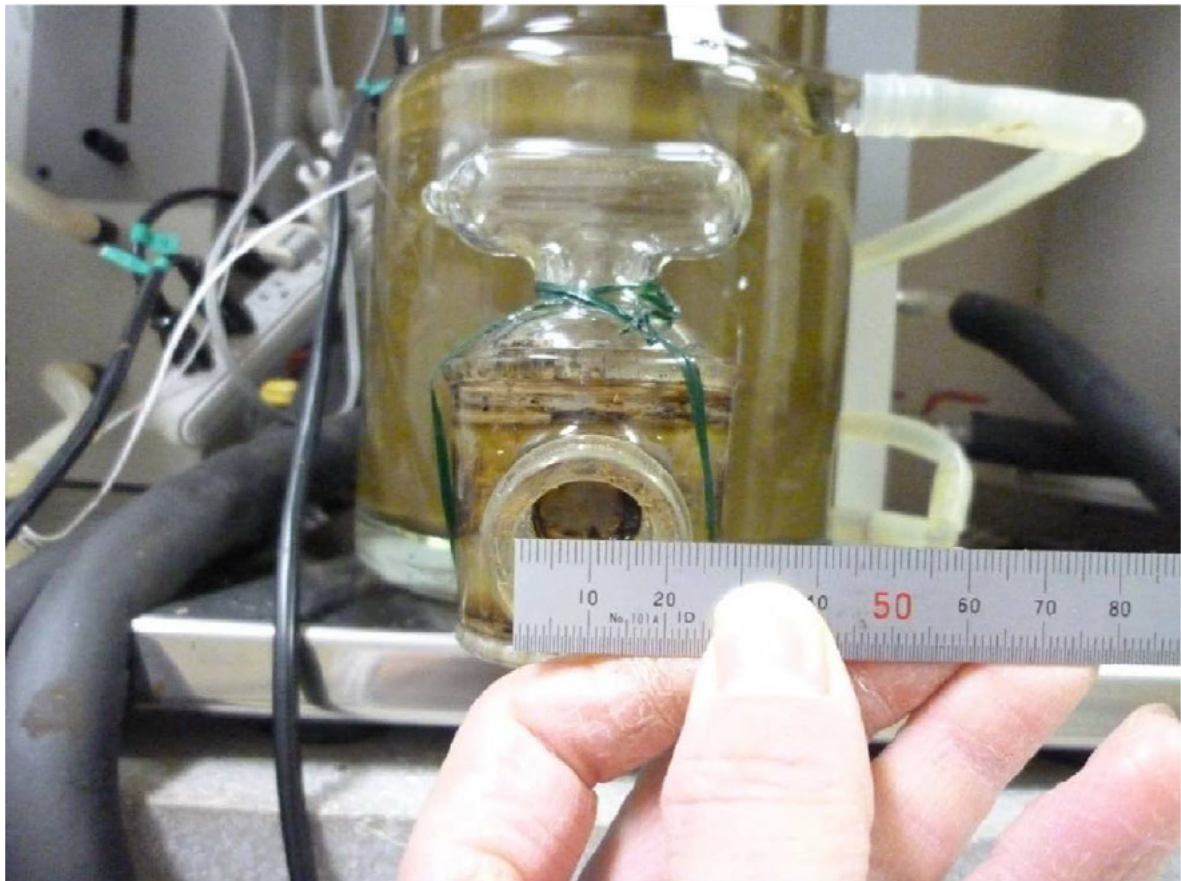
図 3 - 8 発酵槽の消化液引抜排出口
