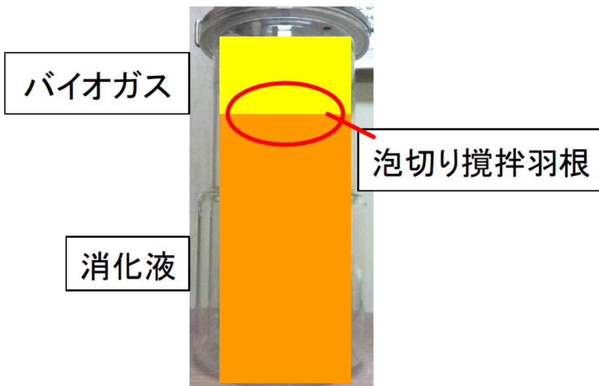
図 4－2 消化液の液面を上昇させた場合の攪拌羽根と消化液の模式図
