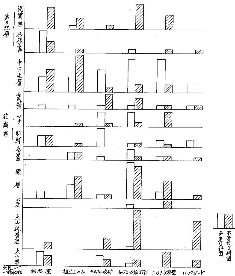
図-4 地質と斜面処理工との関係
