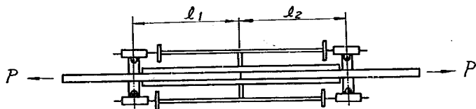
図-5 変形量測定概要
