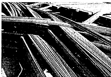
写真-85 ストランドの形くずれ状況
