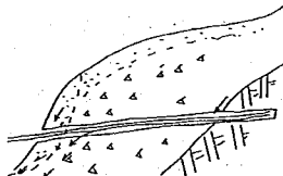
図-1 横ボーリング孔口の崩壊
