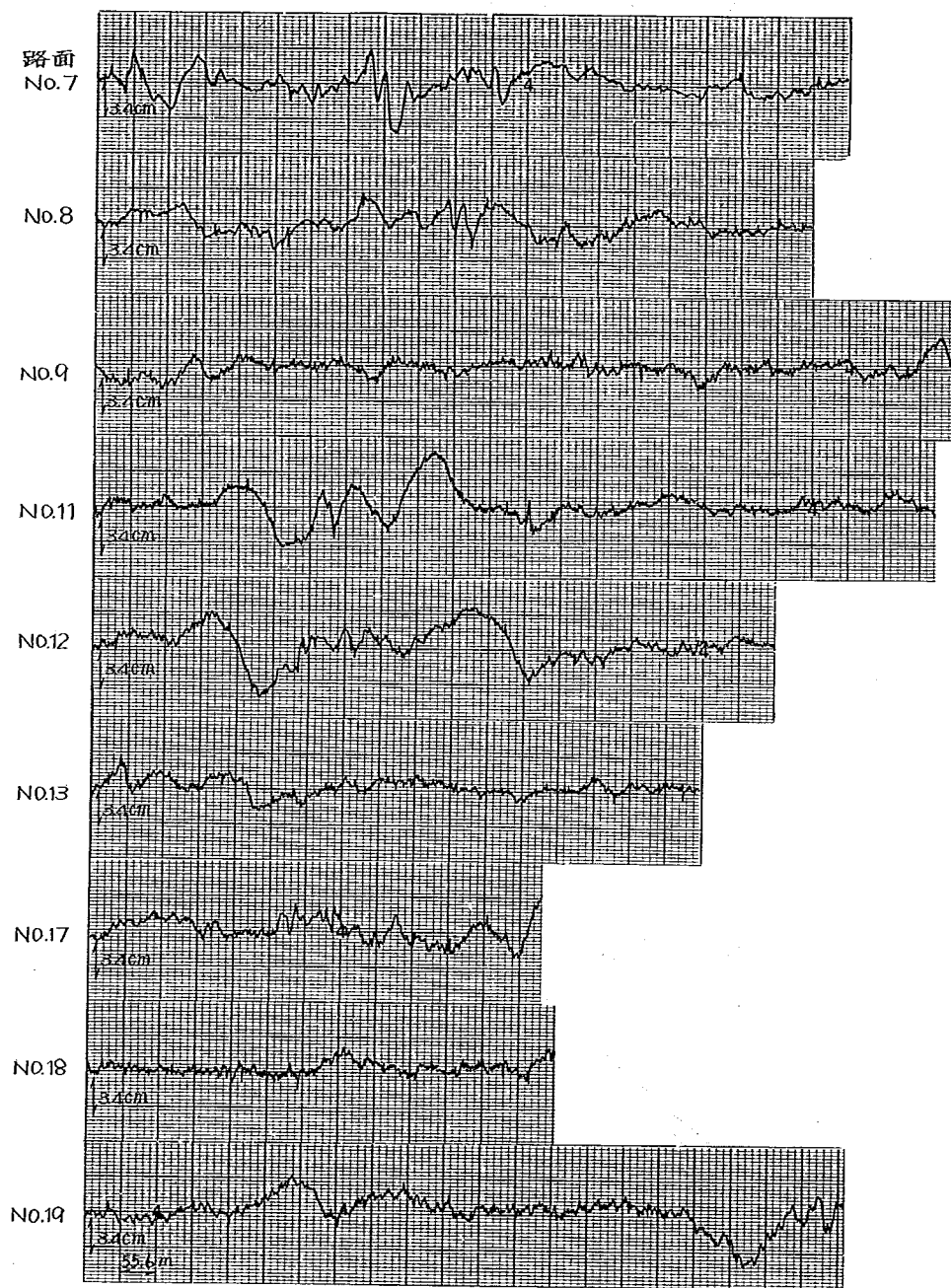
图 2 · 3 国道 16 号線市原市路面凹凸波形
