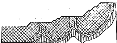
図-14つづき 計算による堤体内の飽和度の変化
