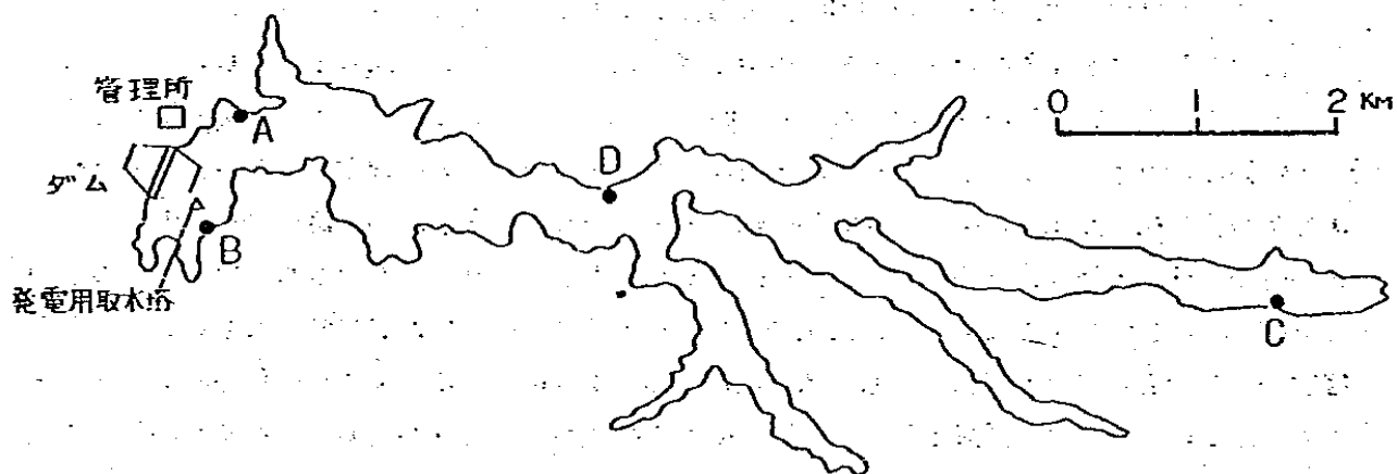
図-1. ダム管理のための水位計の配置検討 (D点からダム寄り及びA点が適当と考えられる)
