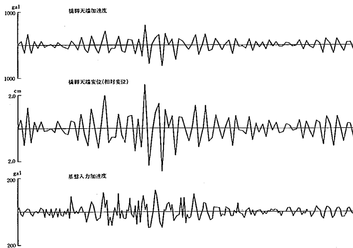
図6-5-8 橋脚天端応答波形
