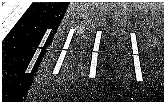
写真3-8 ロードスイッチ(長さ1m)
