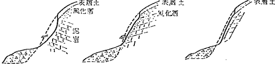
C-a 泥岩層理面の傾斜が斜面と反対の場合
