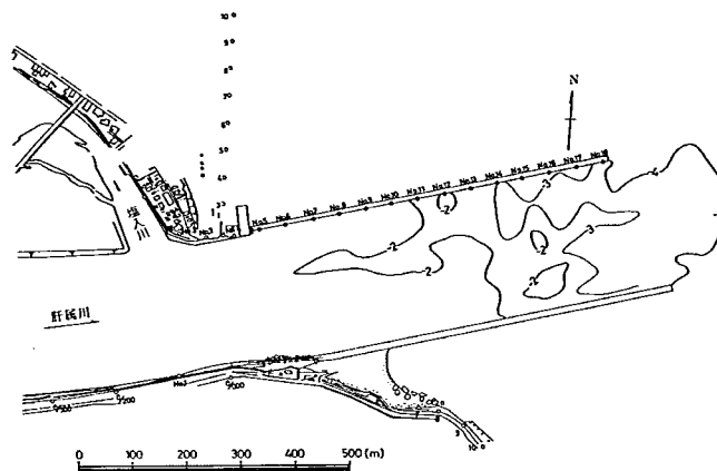
図- 3.28(d) 河口部深浅図 (実験ケース L3, 第二次波浪実験 19 時間後)
