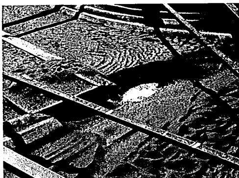
写真-26 合流点の通水後河床状態 <渦の発生により、深掘れ(円形状)が生じている>
