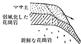
図- 2.1.13 風化花崗岩斜面での崩壊形態の想定
