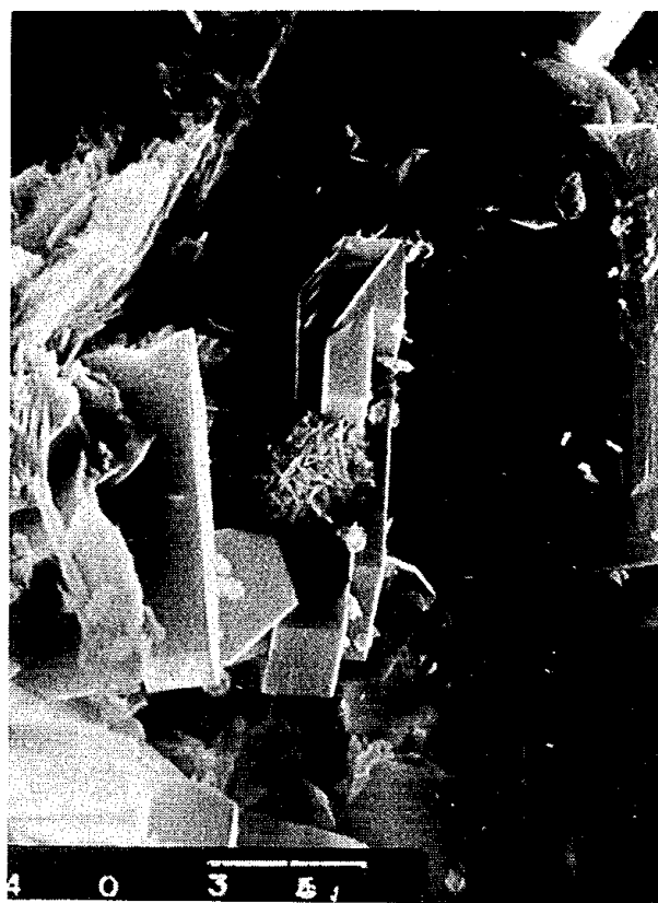
写真-7. 秋田県二ツ井産 Clinoptilolite 中の 異種鉱物 ( 2000 倍 )
