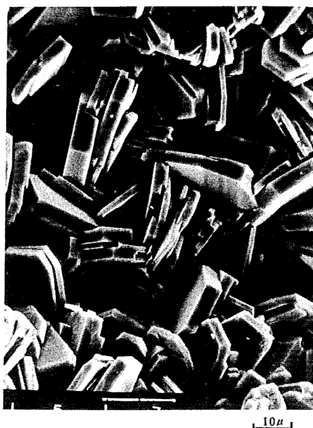
写真-2. 秋田県二ツ井産 Clinoptilolite の結晶 ( 1000 倍 )
