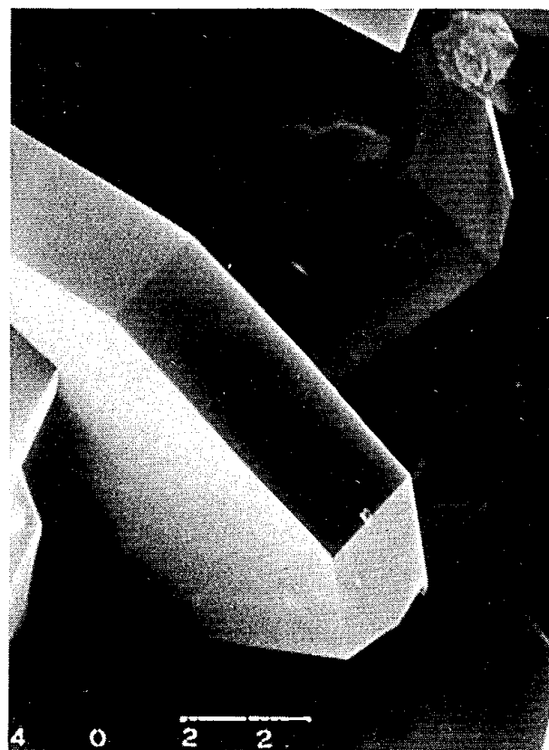
写真-4. 秋田県ニツ井産 Clinoptiliteの結晶 ( 10000 倍 )
