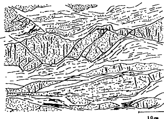
図-9 長島ダムサイト「シャーゾーン」
