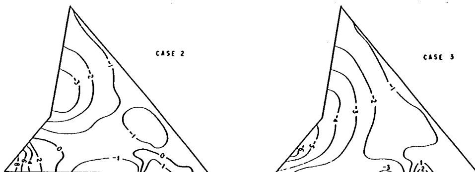
図-6 堤体応力の分布（第1主応力の等高線）
